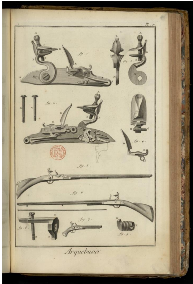
Fig. 1: Views of a mid-18 th -century French flintlock mechanism, lock screws, cock/hammer, frizzen/battery, muskets, false breech, pistol, and breech plug, from Diderot's L'encyclopédie, ou Dictionnaire Raisonné des Sciences, des Arts et des Métiers: Recueil de Planches sur les Sciences et les Arts (Paris, 1770), vol. 1, Plate V. Note the outline of the trigger, below f. 2.
