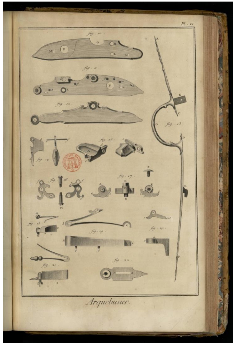
Fig. 2: Trigger guard and constituent parts of a French flintlock mechanism, from multiple vantage points. From Diderot's L'encyclopédie, ou Dictionnaire Raisonné des Sciences, des Arts et des Métiers: Recueil de Planches sur les Sciences et les Arts .
